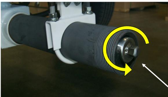
Al mezclar el material por primera vez, le recomendamos que use 1 envase de la caja de la textura adelgazada abajo a una suspensión. Esta es una pre-lubricación del rotor / estator de la bomba y la manguera de material. Bombee la suspensión en la manguera antes de mezclar.
